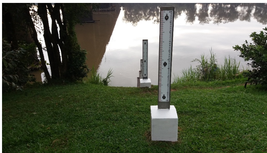
Figura 5.19. Modelo de Régua Linimétrica e sua disposição.
