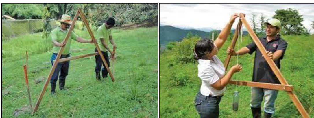
Figura 5.8. Exemplos de marcação de curva de nível com utilização de pé-de-galinha.
